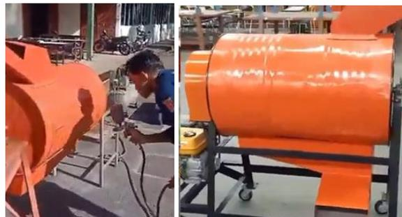
Gambar 9. Proses Finishing Mesin Pemipil Biji Jagung
